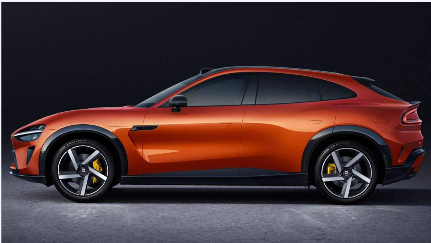
R21-дюймовые колеса Phantom Blade. Спереди 245/45 R21 и сзади 275/40 R21. Michelin Primacy 5 Energy.
